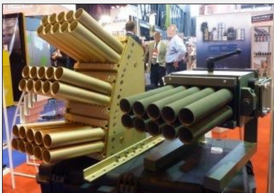
◀ Lanzagranadas menos letales de múltiples cilindros apilables
