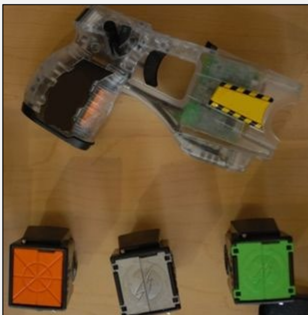
▲ Pistola eléctrica de proyectiles con cartuchos de diferentes potencias
