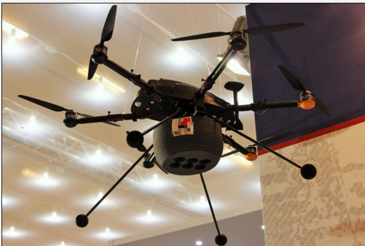
▲ Un vehículo aéreo no tripulado con un lanzador incorporado
