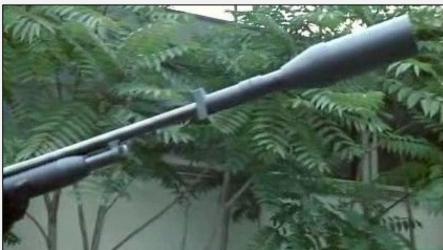
◀▲ Godet de lancement avec grenade de 38 mm
