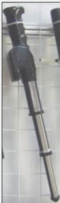
▲ Matraque à décharge électrique télescopique / extensible avec électrode à bande métallique
