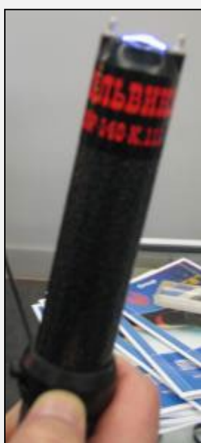
◀ Matraque à décharge électrique à deux électrodes
