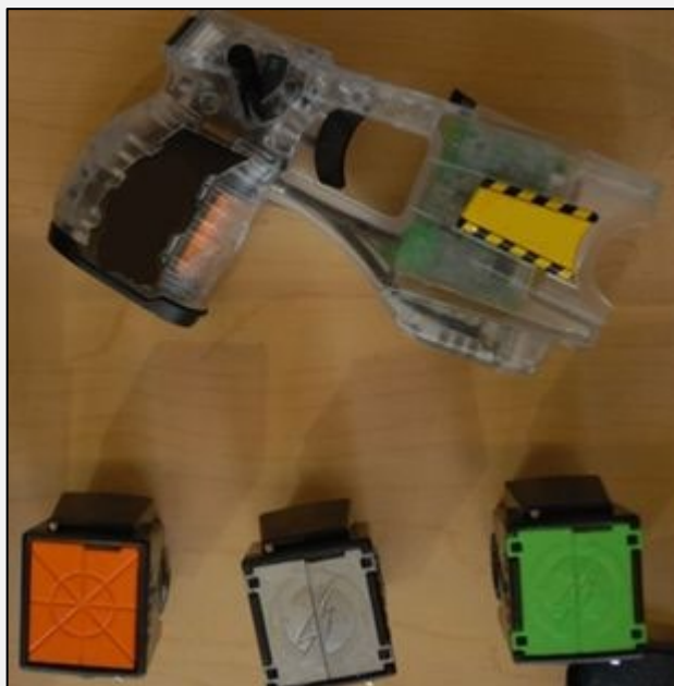
▲ Pistolet paralysant à projectiles avec cartouches de différentes portées
