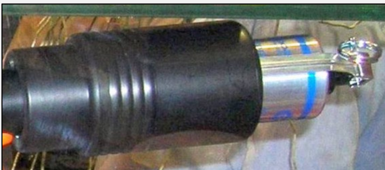
▲ Godet de lancement avec grenade de 38 mm
