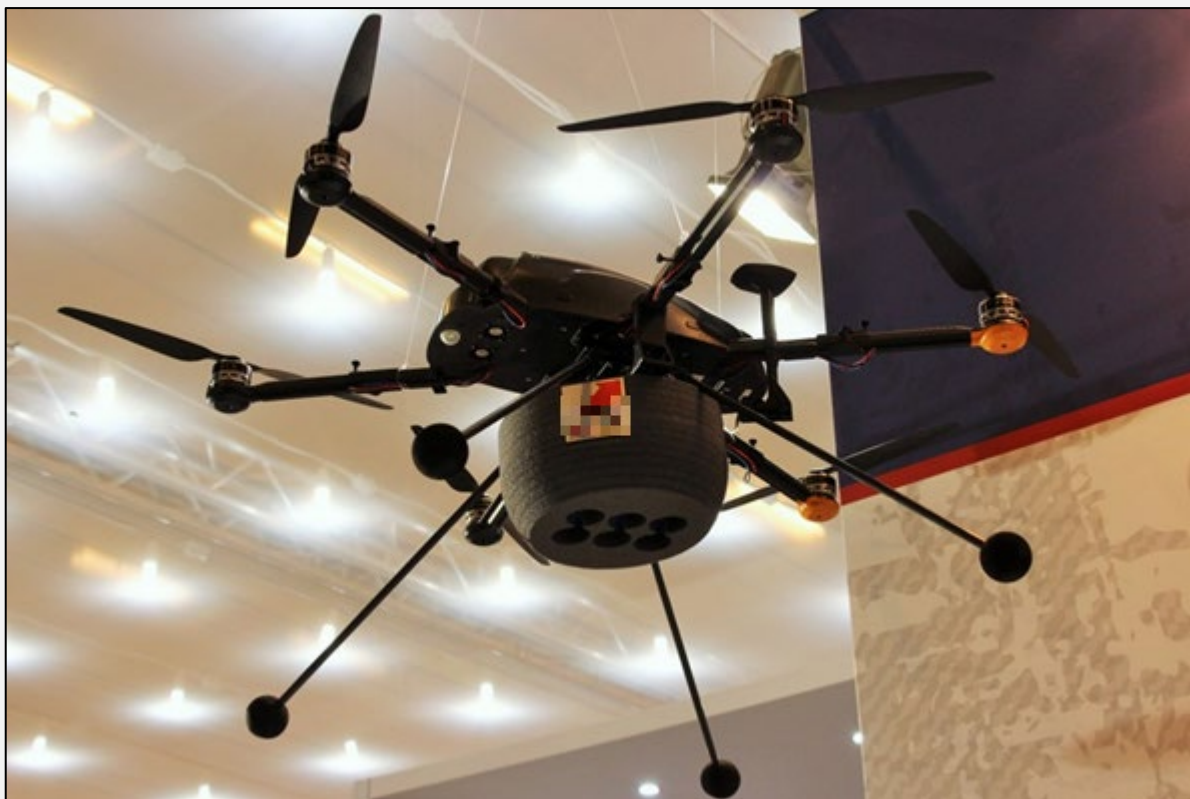
▲ Un drone (véhicule aérien sans pilote) équipé d'un lanceur
