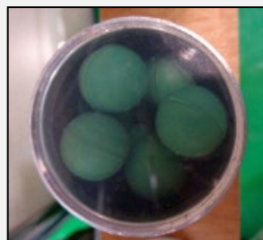
▲ Cartouche de calibre 44 à projectiles multiples en caoutchouc
