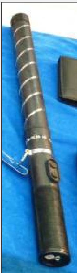
▲ Matraque à décharge électrique avec électrode en spirale métallique
